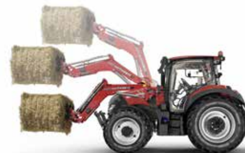
Chargeur frontal LRZ avec parallélogramme mécanique Z.
