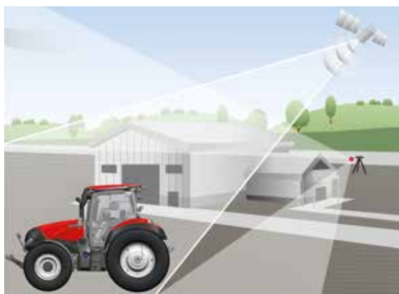
xFill compense les pertes de signaux RTK+ pendant 20 min.
