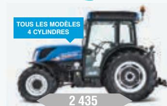
Empattement avec pont avant SuperSteer™ (mm)
